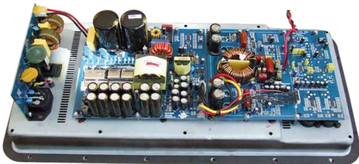
Na dwóch głównych płytach drukowanych umieszczono końcówkę o mocy rzeczywistej (!) 1000 W RMS, zasilacze i układy wejściowe.
