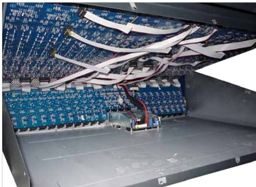
Całą elektronikę zamontowano na kilku dużych płytach drukowanych połączonych wiązkami przewodów z wielowtykami.
