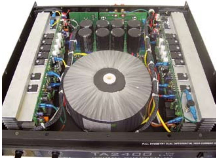
Do niedawna jednym z najbardziej kosztownych elementów wzmacniacza byłaby jego zasilacz, a przede wszystkim transformator sieciowy, który w końcówkach dużej mocy potrafił ważyć kilkanaście kilogramów.
