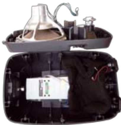
Fot. 7. Końcówka mocy w klasie D, zastosowana w niewielkiej paczce aktywnej, w połączeniu z lekkimi przetwornikami pozwala na znaczne zredukowanie masy zestawu.
