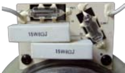
Fot. 5. Mimo wbudowania elektronicznych limiterów producent zastosował dodatkowe zabezpieczenia głośnika wysokotonowego.
