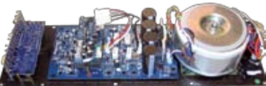
Fot. 4. Moduł aktywnego wzmacniacza dwukanałowego – popularna konfiguracja w nieco droższych zestawach aktywnych. Dwie niezależne końcówki mocy zasilają głośnik 15" i driver wysokotonowy, a podział pasma zapewnia wbudowany, aktywny crossover.
