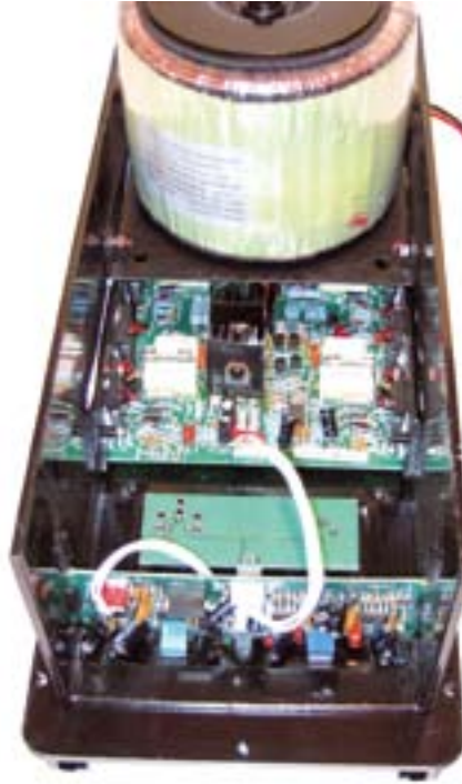
Fot. 3. Moduł wzmacniacza basowego o mocy 400 W z końcówką w klasie H.
