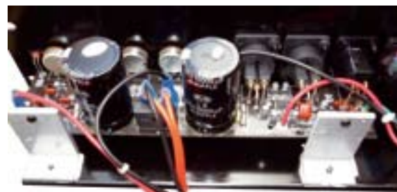
Fot. 1. Prosty wzmacniacz aktywnego monitora, wykorzystujący jako końcówkę scalony wzmacniacz mocy.
