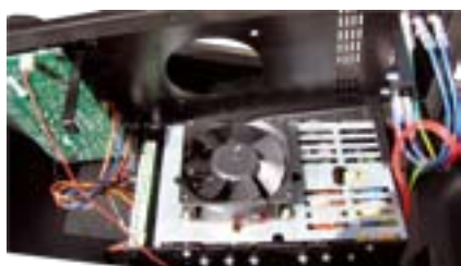
Fot. 6. Nowoczesna, cyfrowa końcówka beztransformatorowa z wymuszonym chłodzeniem.
