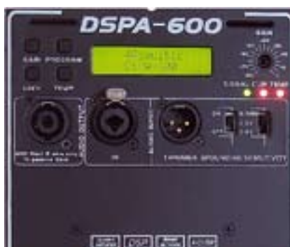
Fot. 8. Nowatorska koncepcja głośnikowego modułu procesora cyfrowego zintegrowanego z końcówką mocy, przeznaczonego do wbudowania w kolumnę aktywną – czyżby najbliższa przyszłość?
