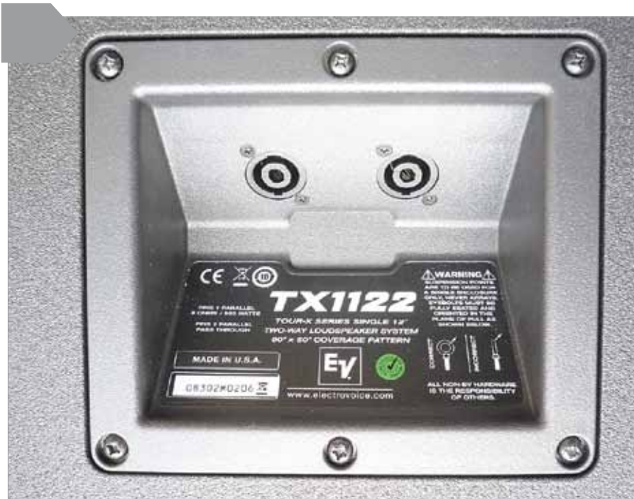
Wszystkie zestawy posiadają identyczne, wpuszczone w głąb obudowy gniazda przyłączeniowe – wygodne rozwiązanie dla zabezpieczenia złączy w trakcie pracy.
