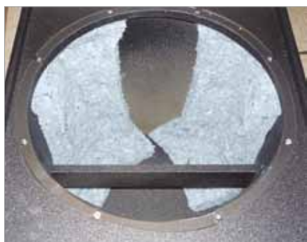
Wnętrze subwoofera wytłumiono niewielką ilością włókny – na zdjęciu widoczne są wewnętrzne wzmocnienia obudowy, której płyta czołowa wykonana jest ze sklejki – pozostałe ścianki, podobnie jak w całej serii, są z MDF.
