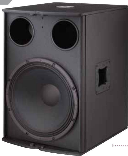
Subwoofer to klasyczny bass-reflex z głośnikiem 18", zamontowanym w obudowie o objętości około 160 litrów.
