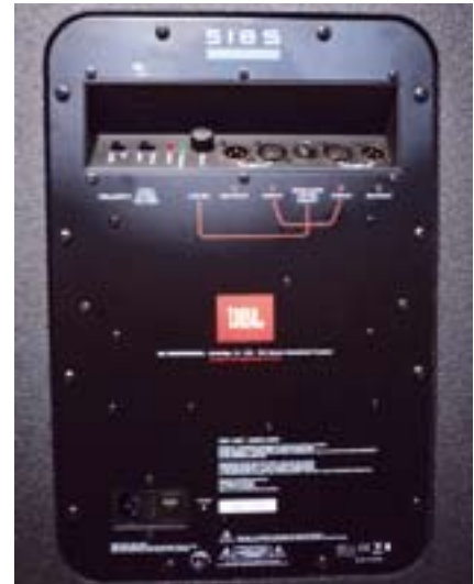
Moduł wzmacniacza: rolę elementu chłodzącego spełnia prosty kawałek blachy aluminiowej o wymiarach 40 x 16 cm. Dzięki wydajnej klasie D nie ma konieczności stosowania dużych radiatorów ani chłodzenia wymuszonego. Moduł wejściowy zajmuje całą szerokość panelu wzmacniacza, a jego umiejscowienie sprawia, że przyłącza są dobrze zabezpieczone w transporcie, a jednocześnie wygodne w obsłudze.
