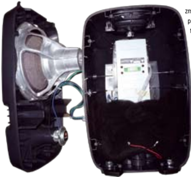
„Przełożwiona” obudowa z widocznym w głębi modułem końcówki mocy w klasie D.
