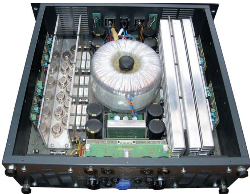
SPA 1800 firmy PMP to przykład konstrukcji wzmacniacza znanej od wielu lat: klasa AB, tradycyjny zasilacz o dużej wydajności z transformatorem toroidalnym. Modułowa konstrukcja ułatwia serwis, wszystkie newralgiczne elementy są bardzo łatwo dostępne, ponadto wzmacniacz posiada komplet zabezpieczeń (m.in. układ soft start i bezpieczniki topikowe w module sieciowym).
