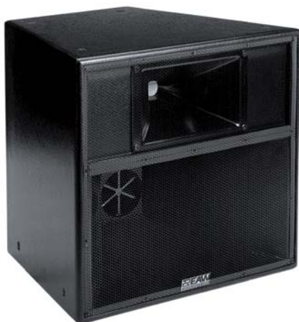
Tuby średnio- i wysokotonowe, oprócz zwiększenia sprawności głośników, pozwalają zapanować nad kierunkowością rozchodzenia się dźwięku. Przekłada się to na lepszą zrozumiałość mowy w mocno pogłosowych pomieszczeniach oraz większy odstęp od sprzężeń akustycznych.
