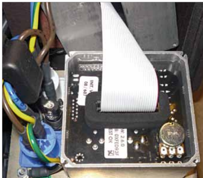
Procesor DSP zamknięto w szczelnej obudowie, z której sygnały wyprowadzono wiązką kablową.
