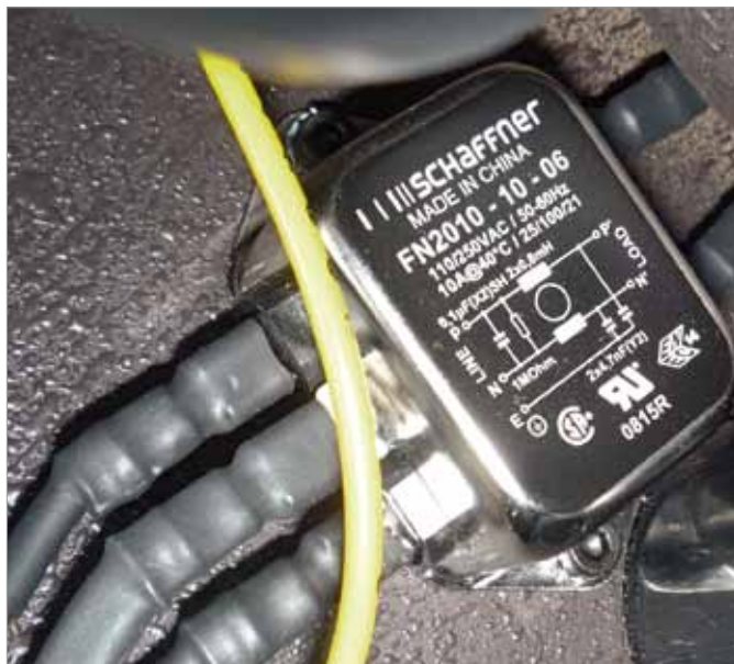
Ważną rolę w testowanych zestawach pełni filtr przeciwzakłóceńowy.
