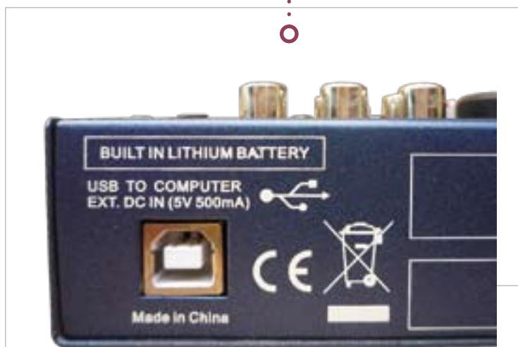
Na tylnej ścianie znajduje się wyłącznie złącze USB do dwustronnej komunikacji z komputerem.
