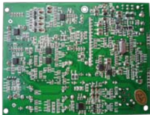
Druga strona płytki to już wyłącznie gęsto upakowane elementy SMD.
