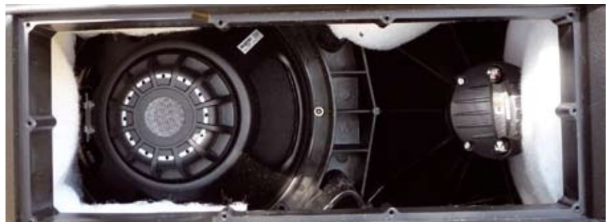
■ Zarówno głośnik 12”, jak i driver to neodymowe przetworniki firmy Celestion.
