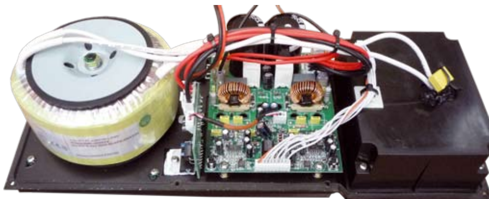
Wzmacniacz mocy sekcji niskotonowej zestawu 12HA to połączenie klasycznego zasilacza z transformatorem toroidalnym i cyfrowej końcówki w klasie D.
