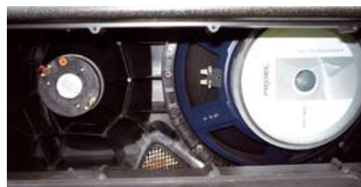
15-calowy głośnik niskotonowy i driver zestawu 15A to przetworniki firmowane przez Proela.
