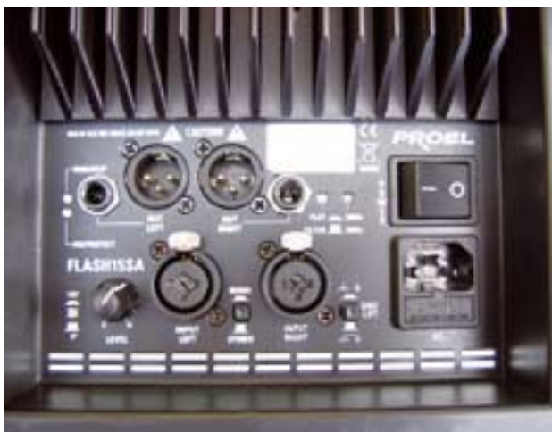
Pod masywnym radiatorem znajduje się bogato wyposażony moduł wyjść i wyjść subwoofera. Wszystkie gniazda i manipulatory są doskonale zabezpieczone dzięki znacznemu zagłębieniu w obudowie.
