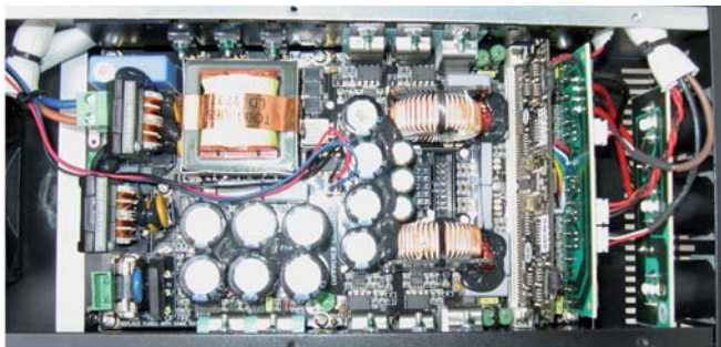
Moduł stereofonicznej końcówki mocy firmy Powersoft, której wyroby coraz częściej stosują inni producenci.
