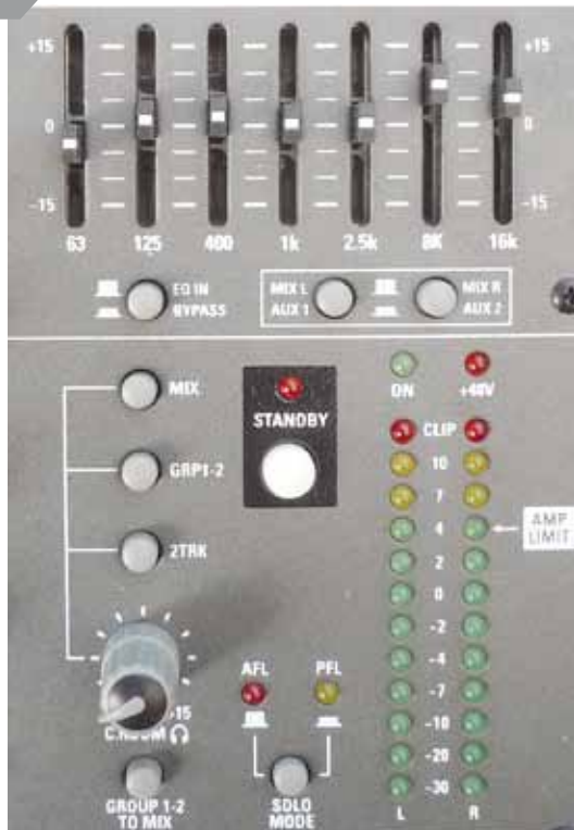
Sekcję główną miksera wyposażono w unikalną funkcję „STANDBY” przydatną w pracy na żywo. Korektor graficzny możemy przełączyć między obsługą wyjść głównych i torów AUX.
