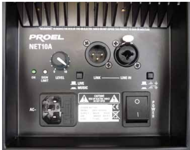
Moduł wejściowy z widocznym radiatorem końcówek mocy.
