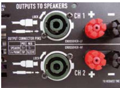
Producent uzupełnił popularne złącza Speakon o gniazda zaciskowe.
