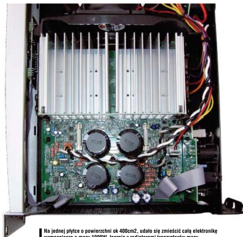
Na radiator końcówki mocy nałożona jest preszpanowa nakładka, zwiększająca skuteczność chłodzenia i izolująca radiator od obudowy.
