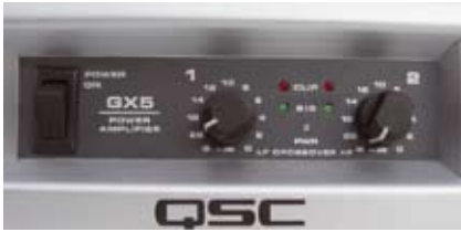
Wyłącznik sieciowy, potencjometry i elementy kontrolne na przednim panelu zabezpieczono od uszkodzeń mechanicznych, przez umieszczenie ich we wgłębieniu płyty czołowej.
