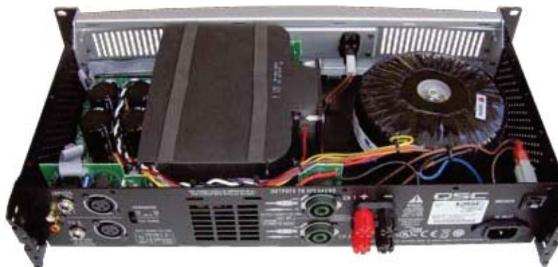
Na radiator końcówki mocy nałożona jest preszpanowa nakładka, zwiększająca skuteczność chłodzenia i izolująca radiator od obudowy.
