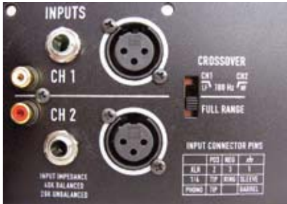
Oprócz standardowych wejść XLR i Jack, wzmacniacz wyposażono w złącza cinch, dzięki czemu łatwo połączyć końcówkę z dowolnym źródłem sygnału.
