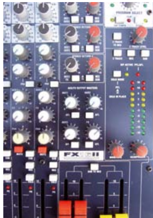
■ Fragment sekcji master z widocznym LED-owym wskaźnikiem kontroli sygnałów o stosunkowo wąskim zakresie działania, bo tylko \pm 16 dB w stosunku do poziomu zerowego.
