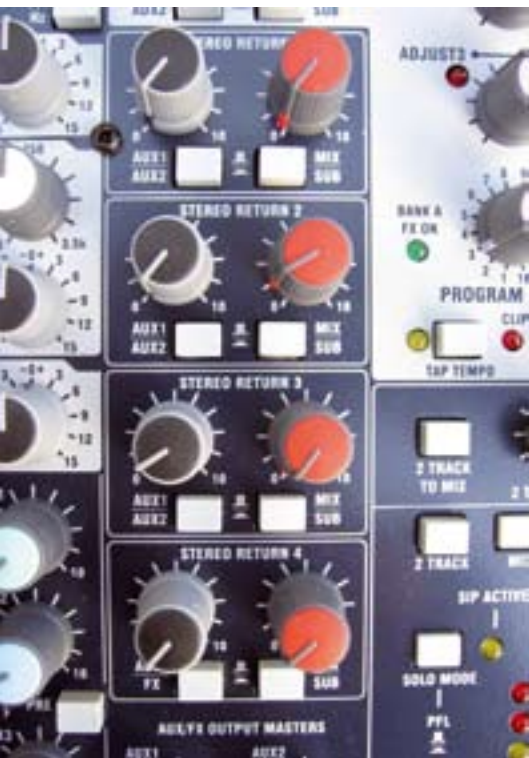
Sekcja 4 niezależnych powrotów stereo z regulatorem poziomu i możliwością wysyłki do kilku torów wyjściowych. Jej obecność w pewnym stopniu rekompensuje brak klasycznych torów stereofonicznych w mikserze.
