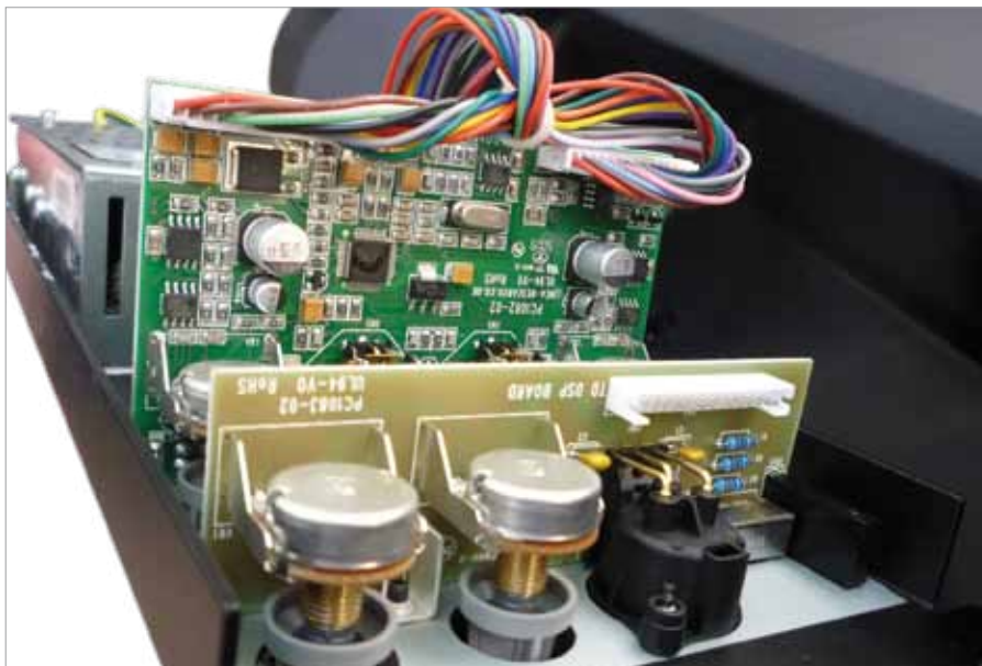
Obwody wejściowe i procesor sygnałowy DPS – zaawansowana technologia na niewielkiej płytce drukowanej.
