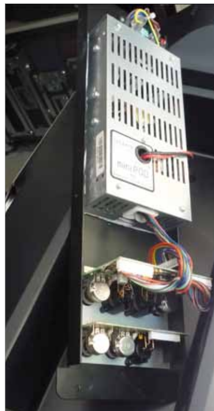
Elektronika renomowanej brytyjskiej firmy Linea Research – w metalowej obudowie zamknięto moduł końcówki mocy, który nie posiada wentylatora.
