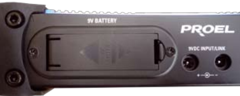
Producent tego DI-boxa dla wygody użytkownika wyposażył go w trzy rodzaje zasilania: z napięcia Phantom, z zewnętrznego zasilacza (z możliwością przekazania napięcia na kolejne urządzenia) oraz z baterii 9 V.
