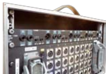
DI-box zamocowany w racku stanowi pożyteczne uzupełnienie profesjonalnego stage-boxa. Na zdjęciu pokazano wersję pasywną, która nie wymaga zewnętrznego zasilania.
