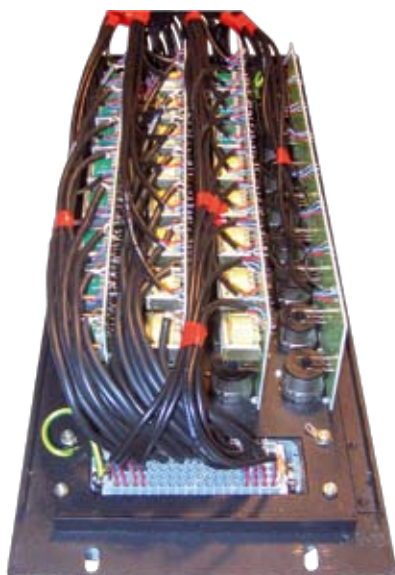
Wnętrze urządzenia – widoczne płytki drukowane, na których umieszczono wszystkie gniazda oraz transformatory separujące.
