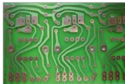
Fragment płytki drukowanej modułu stageboxa – widoczne pola lutownicze gniazd XLR, transformatorów separujących i podłączenia okablowania złącz wielopinowych.
