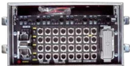
Stagebox-splitter 24/8 z separowanym transformatorowo wyjściem na konsoletę monitorową umieszczony w racku.
