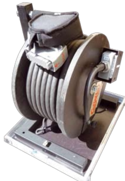
Wykonany „chałupniczym” sposobem bęben kablów, zamontowany w racku transportowym na kółkach: 32 kanały, 30 mb, masa całości: 36 kg. Widoczny futerał zabezpieczający złącze na kablu oraz wykonana z metalu osłona, chroniąca złącze współpracujące ze stageboxem.
