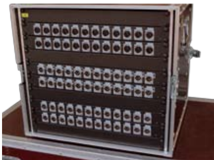
W podstawowej postaci stagebox z funkcjonalnością splittera posiada komplet wejść XLR oraz dwa komplety liczące po tyle samo wyjść.
