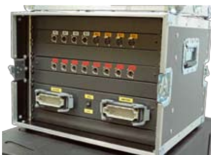
Aby uczynić obsługę splittera wygodniejszą, projektując takie urządzenie można wyprowadzić złącza do konsolet oraz powroty na drugą stronę racka.
