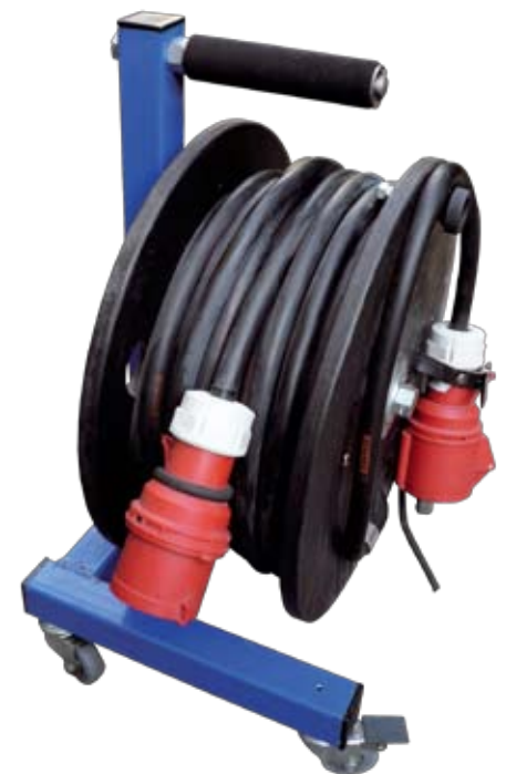
Kabel siłowy nawinięty na bębnie – wygodnie i „elegancko”.
