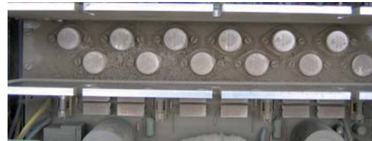
Wzmacniacz, którego właściciel zapomniał, że czasem trzeba przeczyścić jego wnętrze.
