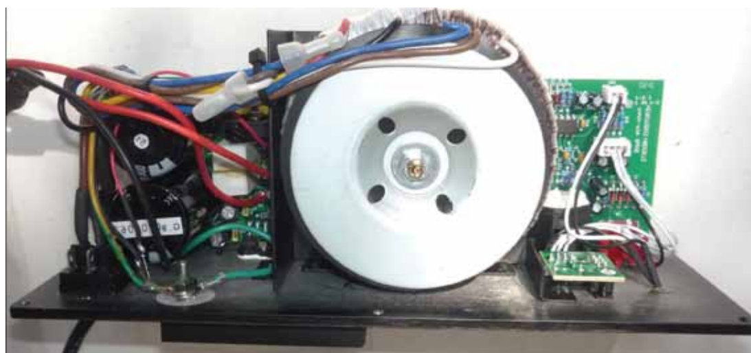
Moduł wzmacniacza mocy i przedwzmacniacza zamontowano na jednej płytce drukowanej.
