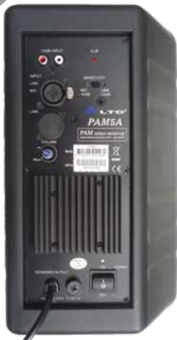
Widok tylnego panelu zestawu z kompletem gniazd przyłączeniowych, wyłącznikiem sieciowym oraz niewielkim radiatorem wspomagającym chłodzenie końcówek mocy.
