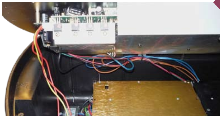
Sekcja miksera znajduje się w oddzielnym, ekranowanym blachą module, dzięki czemu całkowicie wyeliminowano wszelkie zakłócenia sieciowe.
