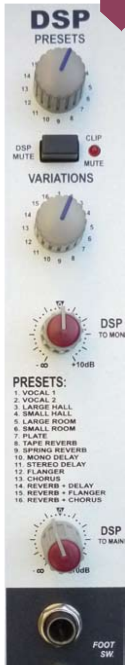
Procesor efektów posiada szesnaście firmowych presetów – parametry każdego z nich ustawiamy przy pomocy szesnastopozycyjnego przełącznika.
