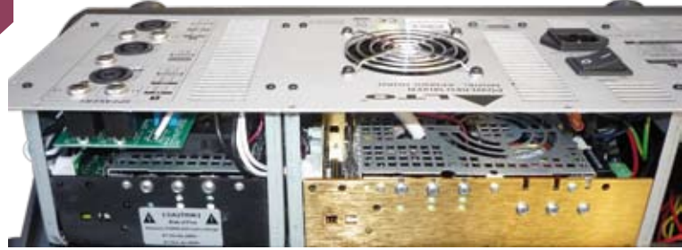
Sercem urządzenia jest moduł poczwórnej końcówki mocy Powersoft oraz oddzielny, impulsowy zasilacz.
