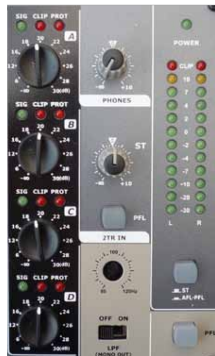
Sekcja kontroli i regulacji końcówek mocy, wyjście mono z filtrem dolnoprzepustowym, regulator poziomu wejścia 2track, słuchawek oraz wielofunkcyjne wskaźniki LED.
