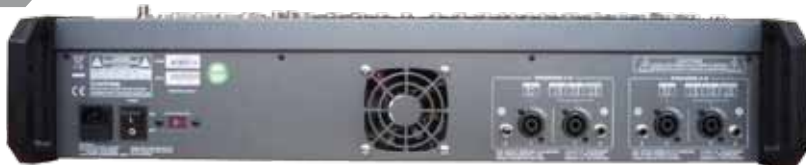
Na panelu tylnym znajdują się wyjścia głośnikowe, wentylator i gniazdo sieciowe z wyłącznikiem.
