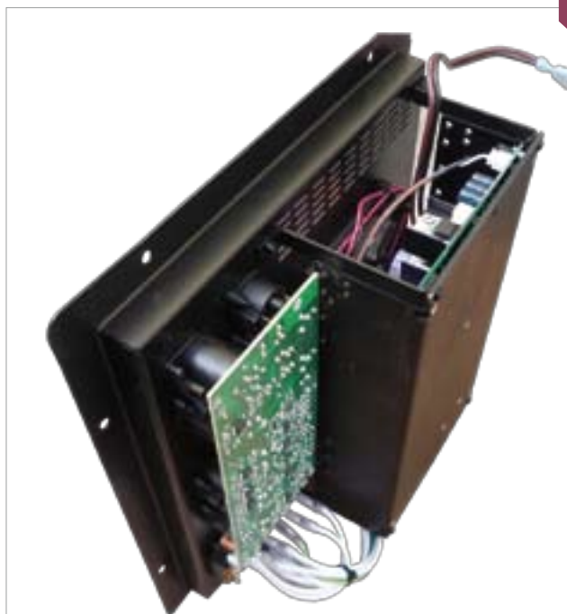
Moduł subwoofera posiada inną płytkę przedwzmacniacza i bardzo zbliżoną konstrukcyjnie końcówkę mocy (jak w zestawach pełnopasmowych).
