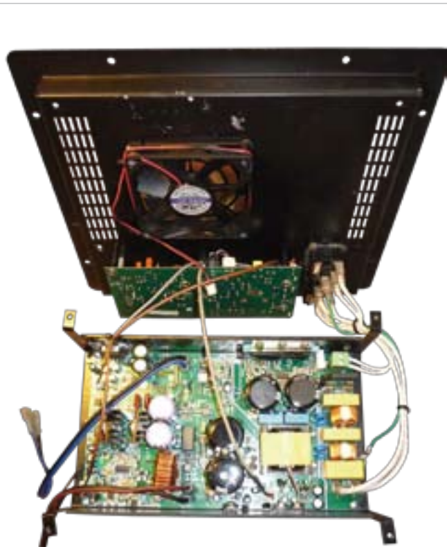
Moduł paczki monitorowej jest identyczny jak w przypadku pozostałych zestawów szerokopasmowych – wszystkie posiadają identyczne gabaryty zewnętrzne i chłodzone są wymuszonym obiegiem powietrza.
