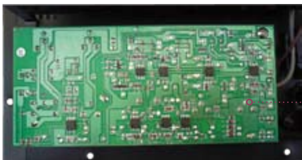
Płytkę przedwzmacniacza subwoofera posiada rozbudowane opcje konfiguracyjne, co narzuciło większe gabaryty i konieczność użycia większej ilości podzespołów niż w zestawach pełnopasmowych.
