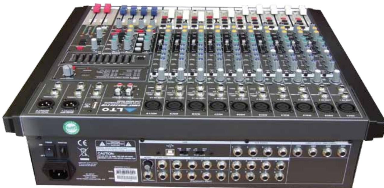
Na panelu tylnym umieszczono wyjścia aux, podgrup, inserty, we/wy USB, gniazdo sieciowe z wyłącznikiem i wyłącznik zasilania phantom, którego aktywność pokazuje dioda na przednim panelu.
