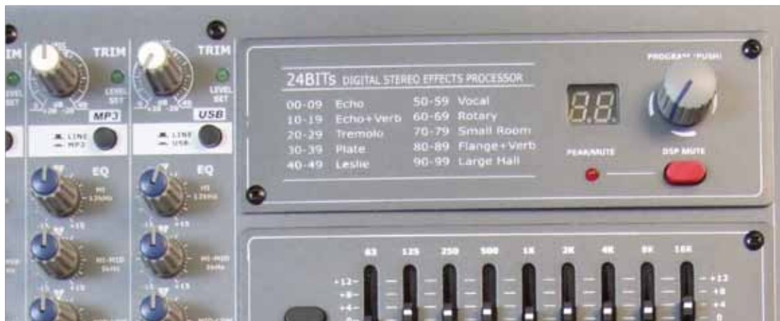
Jeden z widocznych na zdjęciu modułów możemy zastąpić odtwarzaczem MP3. Zdjęcie pokazuje również dwa ostatnie kanały stereo z przełącznikami trybu pracy wejść kanałów.
