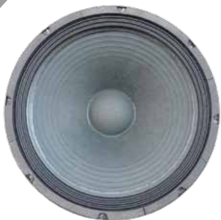
Głośnik 15" zestawu MS 15A posiada cewkę o średnicy 2,5" i magnes o średnicy 155 mm osadzony na koszu identycznym jak ten w subwooferze, zastosowano tu jednak inną, bardziej „szerokopasmową” membranę z ożebrowaniem, które przeciwdziała jej dzieleniu się w zakresie wyższych częstotliwości.
