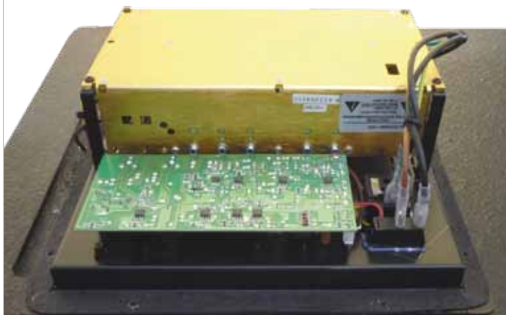
Do napędu subwoofera wykorzystano moduł cyfrowej końcówki, co pozwoliło na uzyskanie w krótkich impulsach mocy ok. 600 W RMS. Na fotce widoczna również płytka przedwzmacniacza i układów wejściowych.
