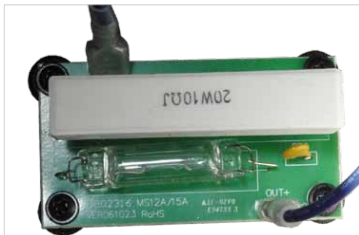
Przetwornik wysokotonowy zabezpiecza układ włączony w szereg z głośnikiem, zmontowany na dodatkowej płytce drukowanej.
