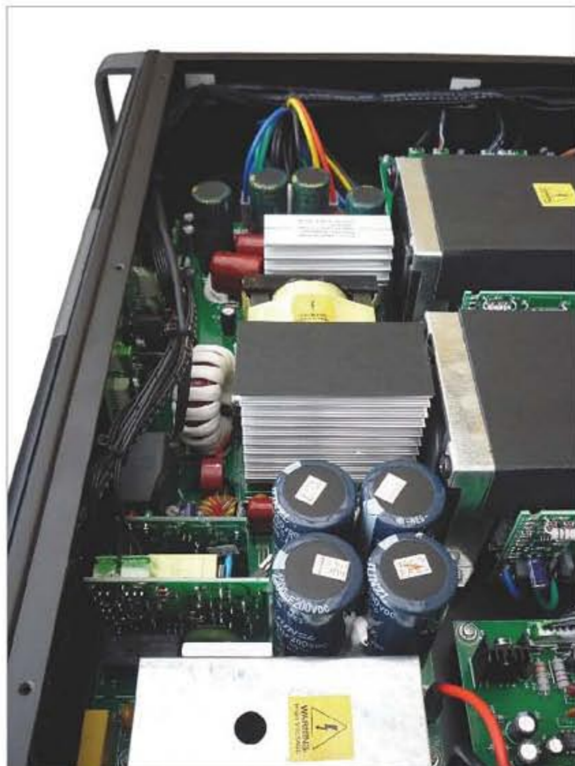
Na zdjęciu na pierwszym planie widzimy sekcję przetwornicy impulsowej.
