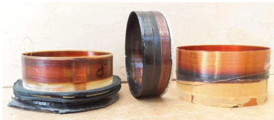
Częstym uszkodzeniem cewek jest przegrzewanie się i, w efekcie, uszkodzenie skrajnych uzwojeń.
