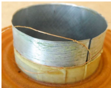
Amatorska próba naprawy uszkodzonej cewki zakończyła się jej całkowitą destrukcją, bo uzwojenia zsunęły się z karkasu i pozostały w szczelinie.
