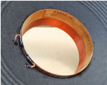
Prawidłowo wklejona i wykonana cewka dwustronna z kompletu naprawczego PMP.
