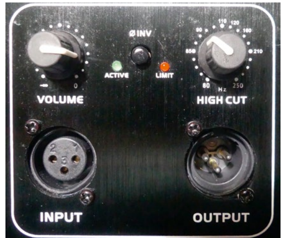
Moduł połączeniowy prostego subwoofera z możliwością płynnej regulacji częstotliwości crossovera.
