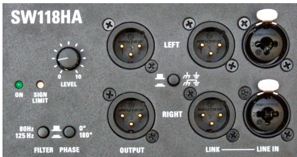
Moduł wejściowy suba z możliwością wyboru dwóch częstotliwości podziału.
