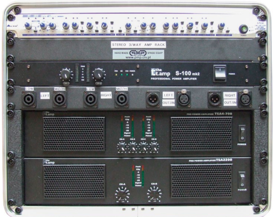
Rack zasilający 3-drożny zestaw nagłaśniający, zbudowany w oparciu o paczki pasywne.
