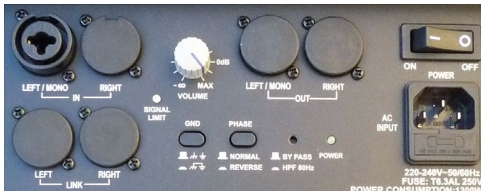
Rozbudowany układ wejść i wyjść aktywnego subwoofera.
