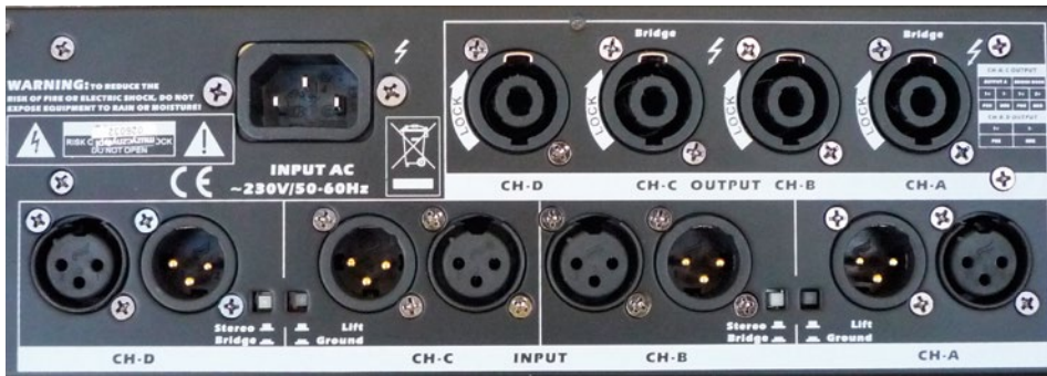
Optymalny układ wejść i wyjść czterokanałowej końcówki mocy z możliwością mostkowania kanałów parami.
