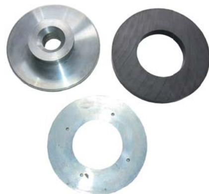
Części składowe obwodu magnetycznego głośnika basowego dużej mocy (PMP 18B / 600): pierścieniowy magnes ferrytowy oraz nabiegunnik dolny i górny, wykonane z materiału o dużej przenikalności magnetycznej (stal niskowęglowa).
