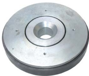
Zdjęcie przedstawia obwód magnetyczny w całości. Widoczna jest szczelina w której porusza się cewka, oraz duży otwór pośrodku, służący do chłodzenia cewki strumieniem powietrza przepompowywanego w trakcie pracy głośnika. Cztery symetryczne, nagwintowane otwory służą do przykręcenia kosza wraz z układem drgającym (membrana z zawieszonymi i cewką).
