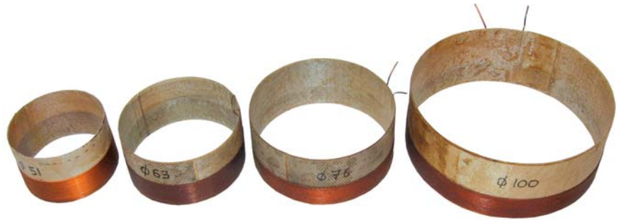
Cewki głośnikowe nawinięte na karkasach z włókna szklanego o standardowych średnicach: 51 mm (2”), 63 mm (2,5”), 76 mm (3”) oraz 100 mm (4”).
