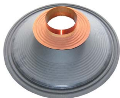
Membrana głośnika 18” z wklejoną cewką o średnicy 100 mm oraz resorem dolnym i górnym – oba wykonane są ze specjalnie impregnowanej tkaniny o odpowiedniej sztywności.
