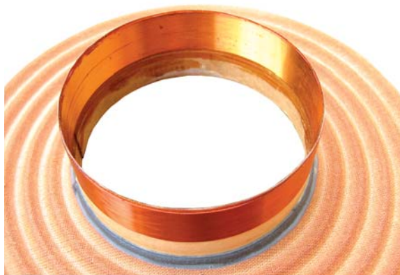
Cewka wklejona w membranę wraz z dolnym resorem – cewka nawinięta jest po obu stronach karkasu, co pozwala na lepsze chłodzenie uzwojeń, w porównaniu do tradycyjnej technologii uzwojenia dwuwarstwowego, nawijanego po jednej stronie karkasu.
