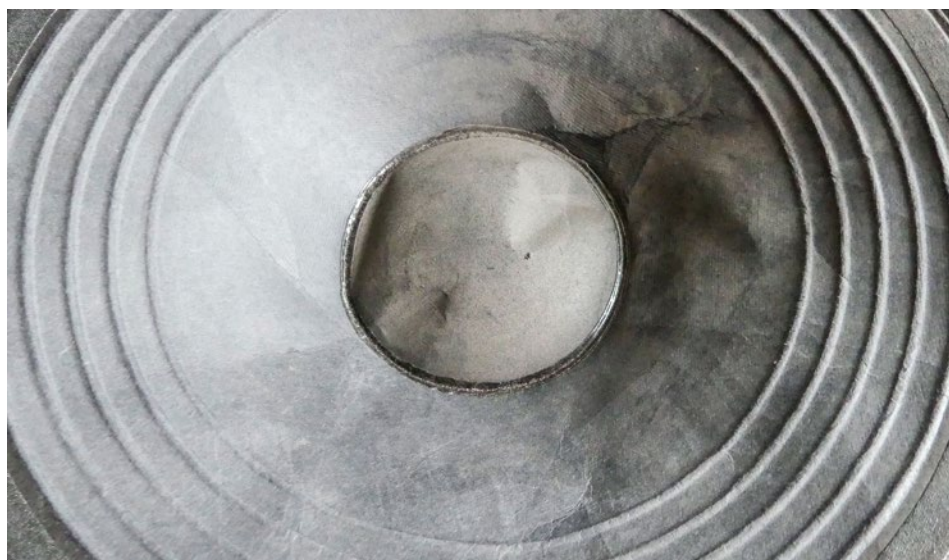
Uszkodzenia membran często wynikają z niewłaściwej aplikacji głośnika.
