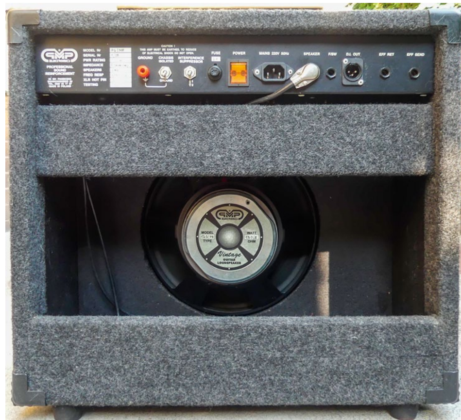
Kombo gitarowe z otwartym tyłem wymaga zastosowania dedykowanego głośnika.
