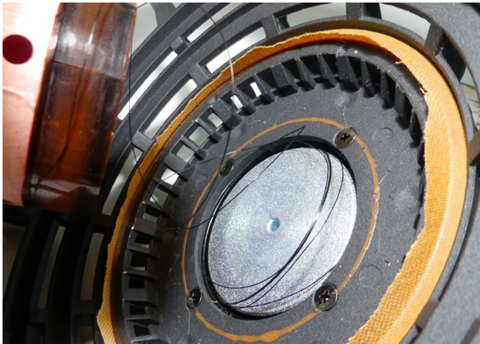
Uzwojenie jednej z cewek w całości znajdowało się w szczelinie obwodu.
