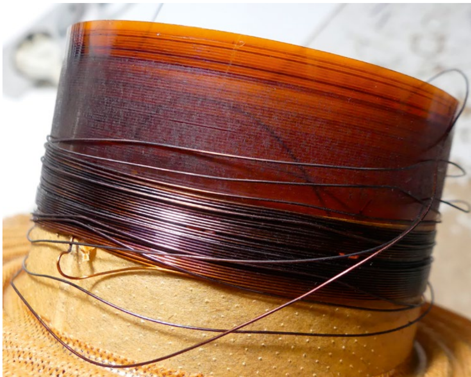
Druga cewka uległa identycznej awarii, spowodowanej wadą technologiczną.
