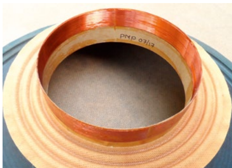
Dwustronna cewka PMP na karkasie z włókna szklanego, użyta w procesie regeneracji profesjonalnego głośnika estradowego Byema.
