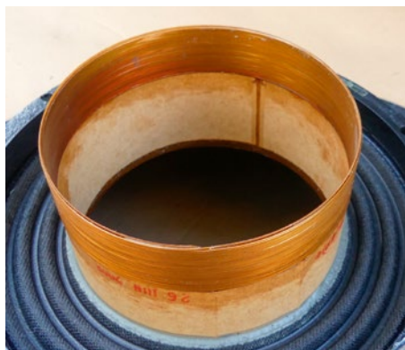
Dwustronna cewka Beyma z głośnika 18P1000ND, nawinięta na karkasie z włókna szklanego.
