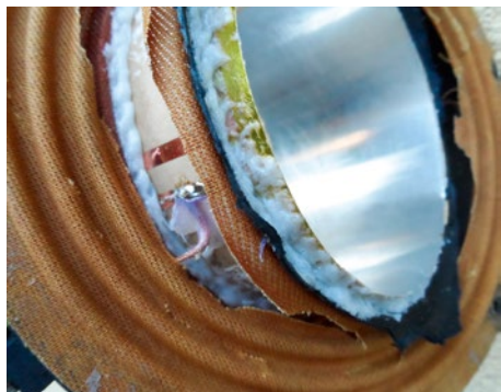
Nieudolna próba naprawy głośnika przy użyciu cewki kupionej jako zamiennik oryginalnej.
