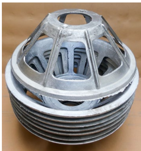
Koszki głośników PMP odlewane są metodą formowania w piasku.
