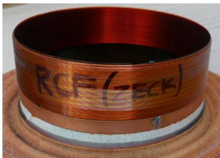
Cewka z głośnika 18" RCF po 20 latach nie wykazuje żadnych uszkodzeń.
