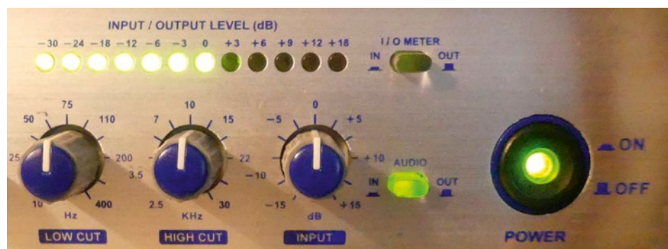
Sygnal szumowy przechodzi przez układ regulowanych filtrów dolno- i górnoprzepustowych.
