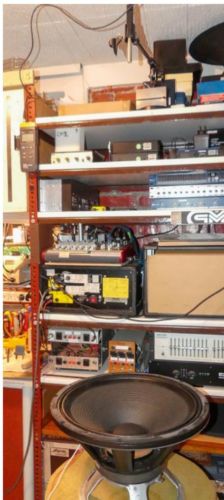
W odległości 1 m od mierzonego głośnika znajduje się mikrofon pomiarowy miernika SPL.
