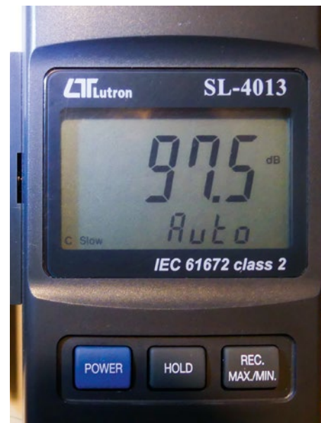
Pomiar ciśnienia akustycznego głośnika Eminence Sigma Pro po regeneracji w serwisie PMP.
