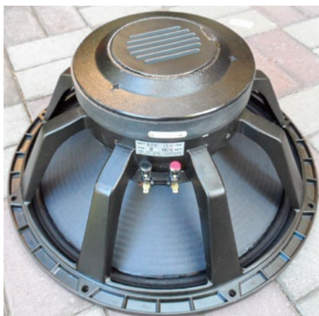
Klasyczny obwód głośnikowy, wykorzystujący magnes ferrytowy.
