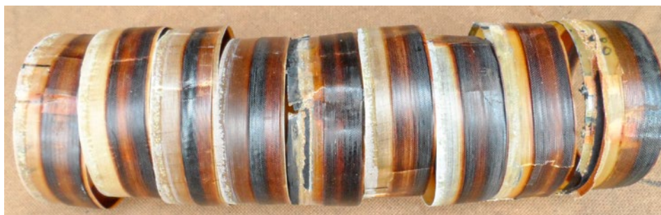
Cienki nabiegunnik i cewka o wysokim uzwojeniu to połączenie, które często prowadzi do uszkodzeń głośników.
