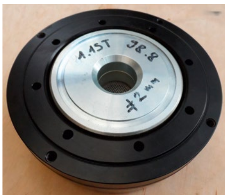
Poziom SPL głośnika w znacznym stopniu zależy od natężenia pola magnetycznego w szczelinie i konstrukcji obwodu magnetycznego.
