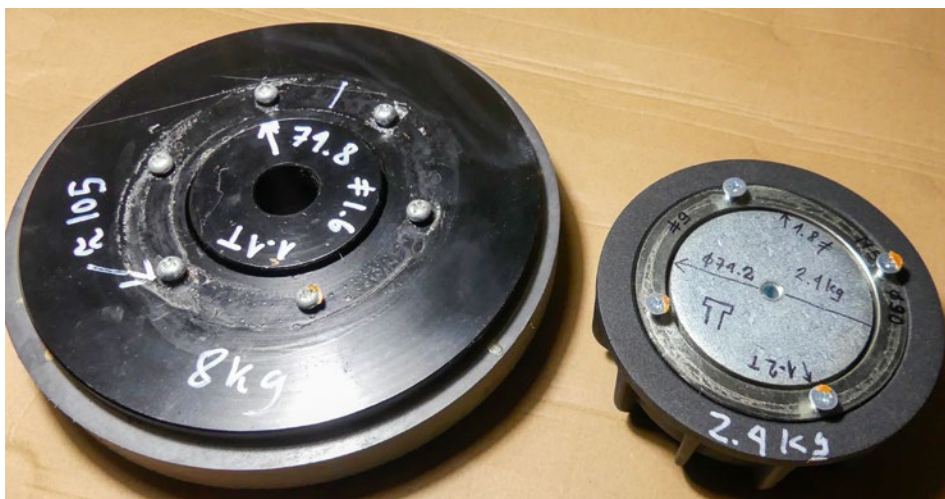
Porównanie parametrów ferrytowego i neodymowego obwodu magnetycznego.
