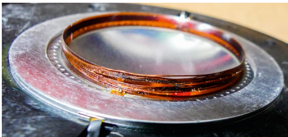
Uszkodzona cewka jednego z driverów.
