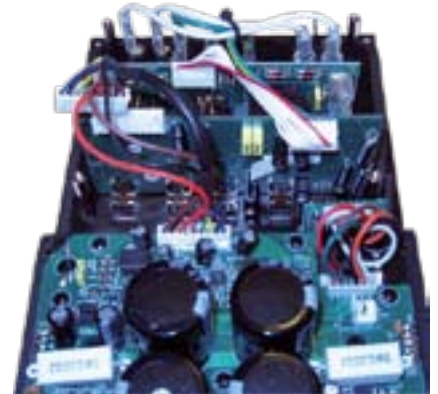
Elektronikę zawierającą oprócz wzmacniaczy układy korekcji oraz zabezpieczeń, producent zawarł na kilku płytach PCB przytwierdzonych do panelu tylnego.
