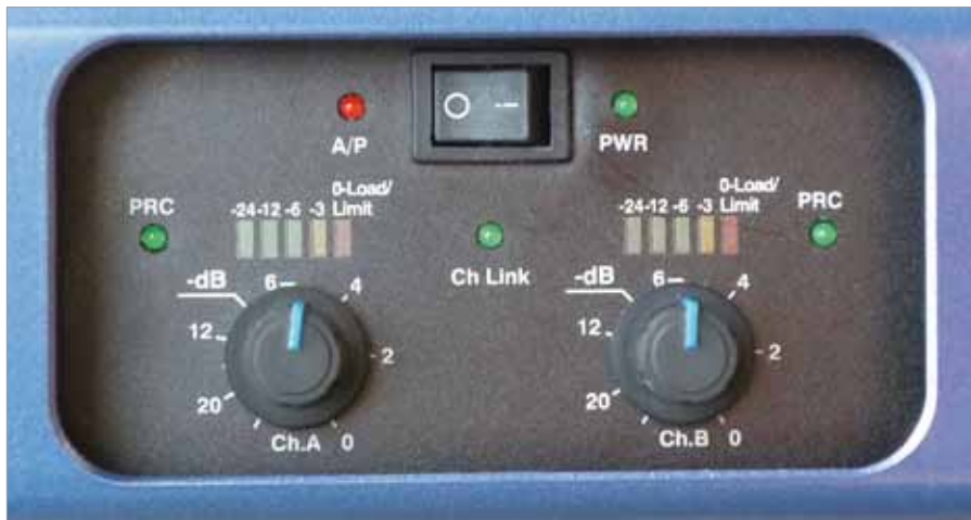
Panel regulatorów i diod kontrolnych schowany jest we wnęce wyfrezowanej w płycie czołowej.
