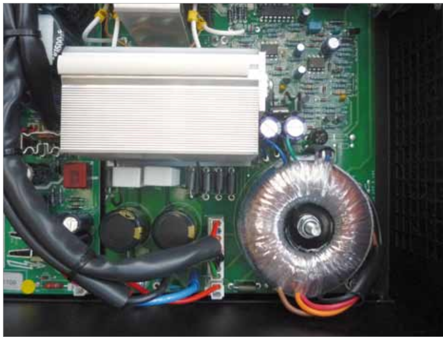
Zasilacz z niewielkim transformatorem toroidalnym jest niezbędny do obsługi obwodów pomocniczych.
