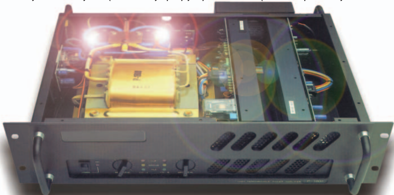
Rys. 1. Przykład typowego, standardowego wzmacniacza mocy. Masywny transformator, duże kondensatory elektrolityczne i radiatory tworzące tunel, którym przepływa powietrze chłodzące tłoczone przez wentylator.
